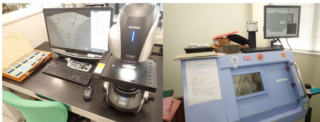
デジタルマイクロスコープおよび X 線透過装置による撮影の様子
