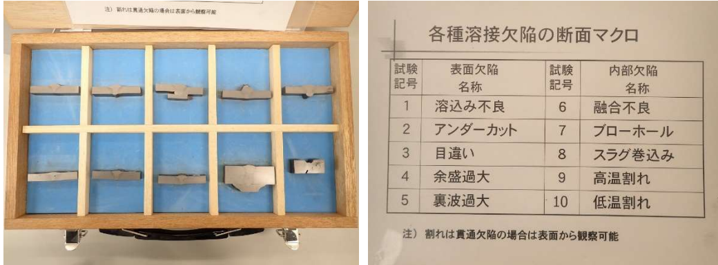
溶接欠陥サンプル (マクロ試験篇)
