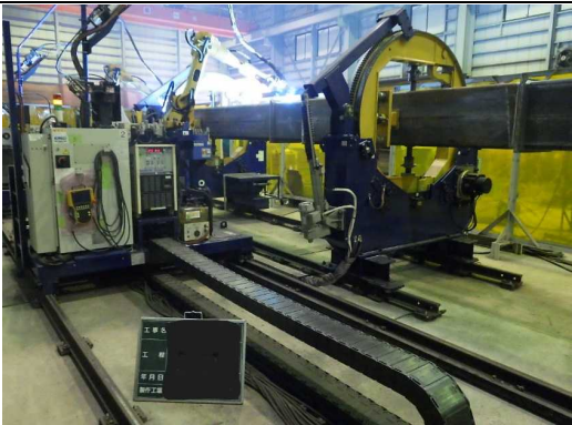
溶接ロボット
